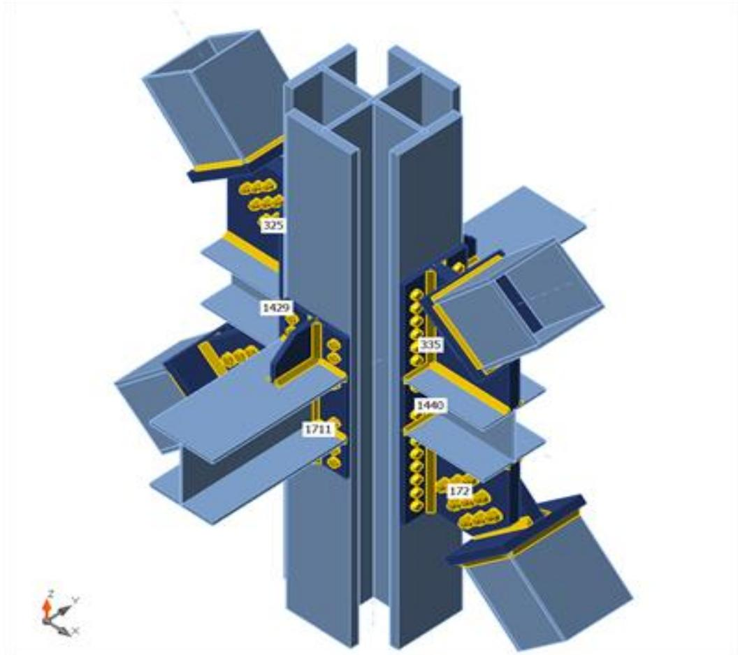
**Figure 7. 13: Vue assemblage poutre Poteau contreventement**
