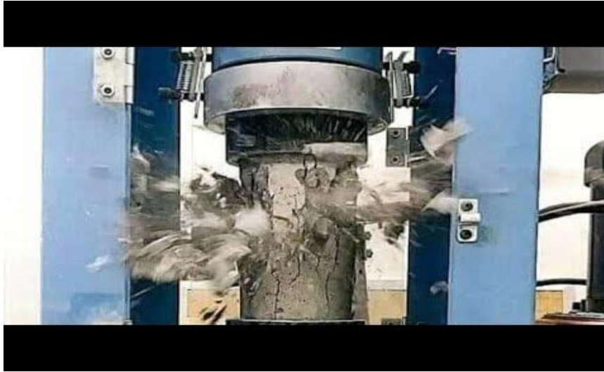
Figure I.2 : Essai de compression de béton
