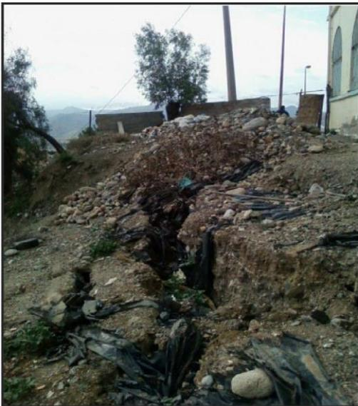
1:Photo montrant les fissures de traction
