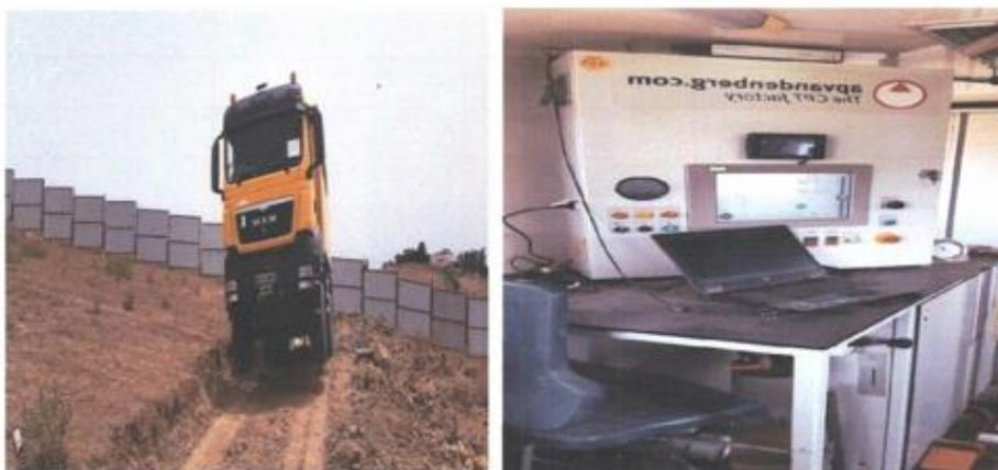
**Figure 3.6** Pénétromètre statique au niveau du site d'étude
