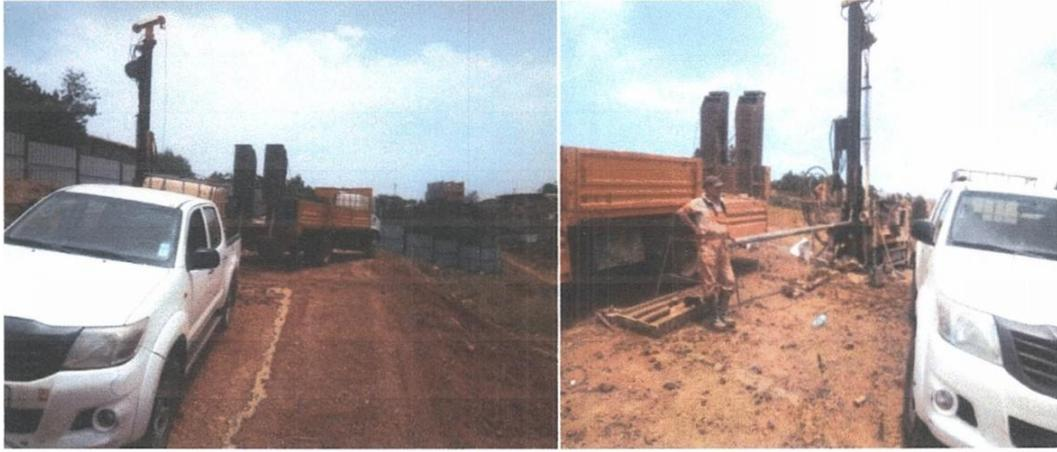
Figure 3.1 Photos montrant les essais de sondage carotté
