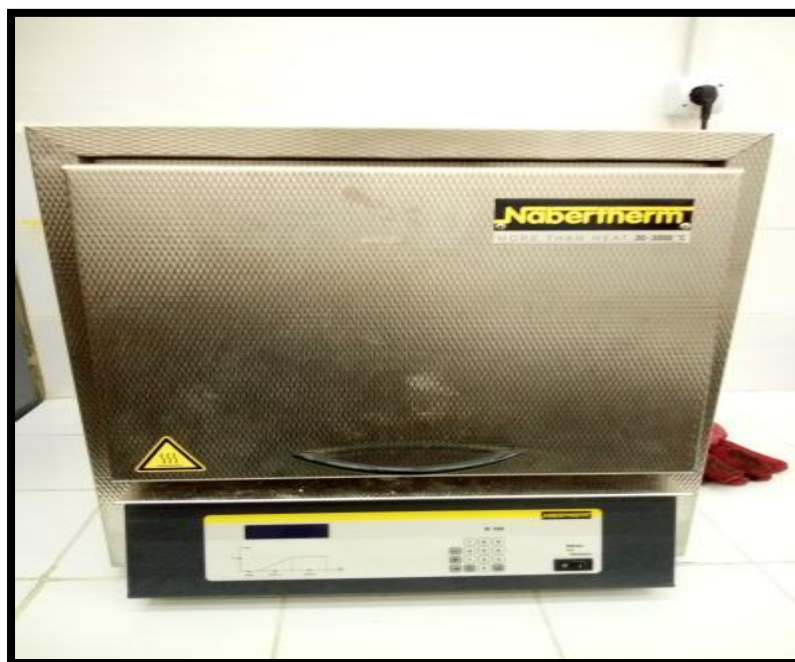
Figure III 6: Four électrique à moufle de laboratoire d'SDM
