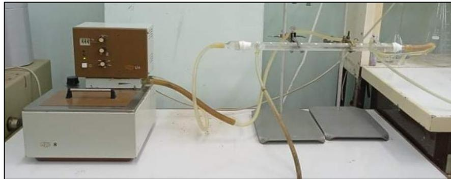
**Figure II.4.** Schéma du montage expérimental de l'installation de l'échangeur en verre.
