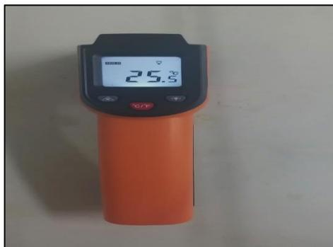
**Figure II.1.** Thermomètre infrarouge.
