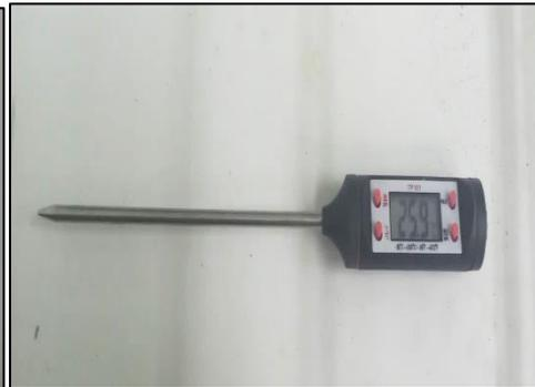
**Figure II.2.** Thermomètre digital.
