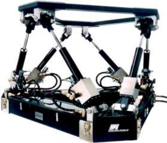
Figure 1.12 – Plate-forme de Gough-Stewart
