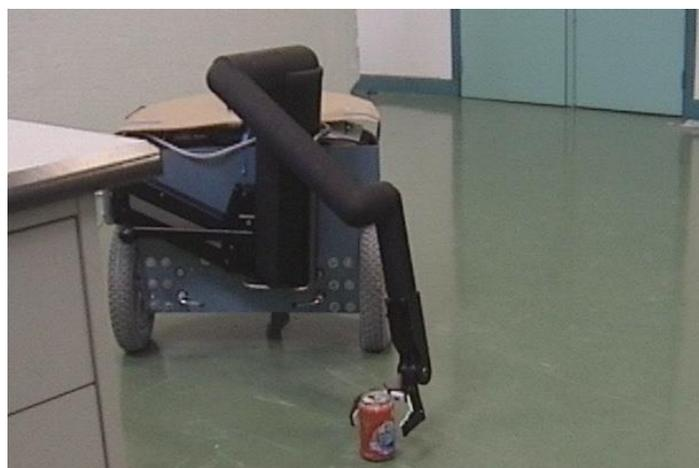
Figure 1.7 – Manipulateur à deux degrés de liberté
