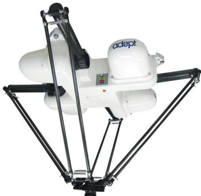
Figure 1.2 – Robot Parallèle
