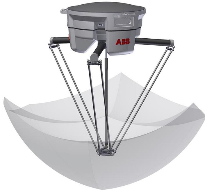
Figure 1.6 – L'espace de travail du robot IRB 360 (FlexPicker) de ABB
