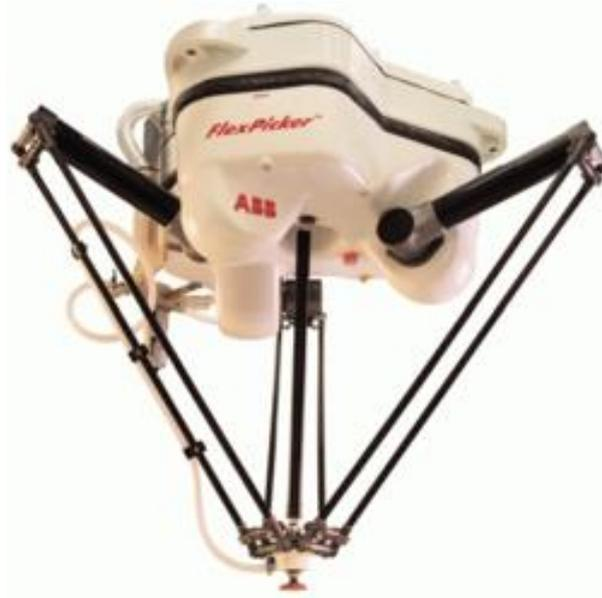
Figure 1.10 – Robot Delta à quatre degrés de liberté
