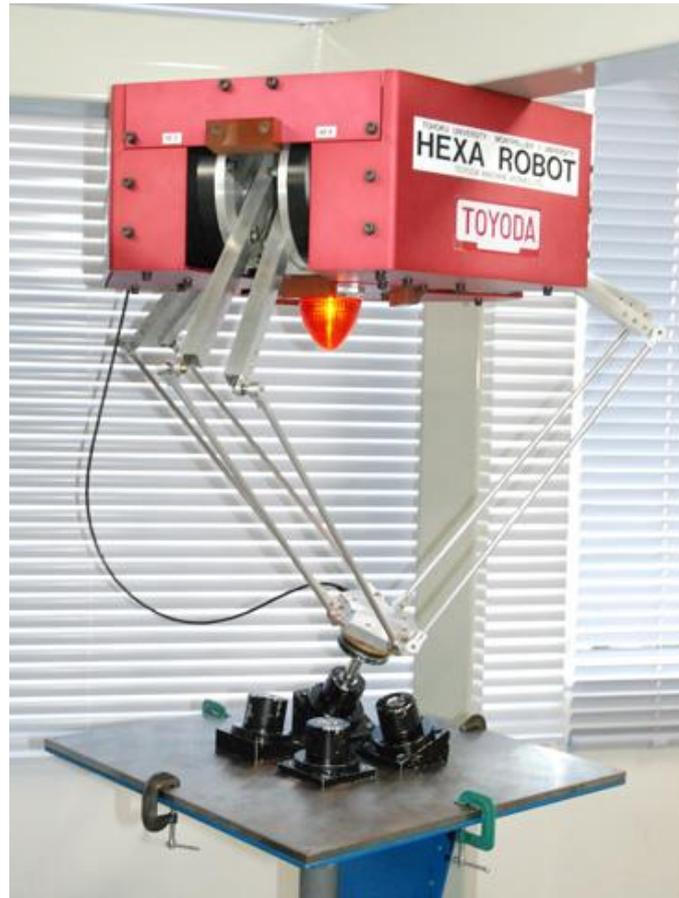
Figure 1.15 – Robot Hexa à six degrés de liberté
