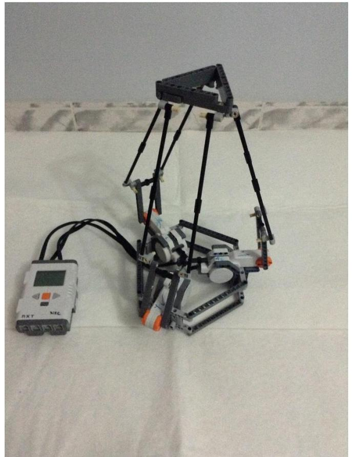
Figure 3.1 Structure du robot Delta Réalisé
