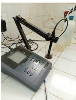
**Figure 24 : Mesuré de la conductivité électrique par le conctivemeter, (originale2022.)**
