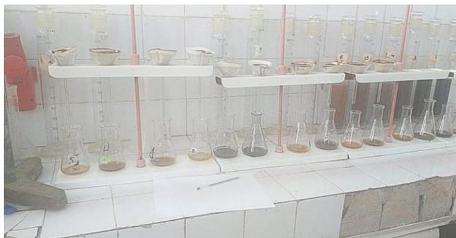
**Figure 22 : La filtration des échantillons du pH.**
