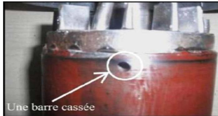
Figure2.7 : Rotor avec une barre rotorique cassée
