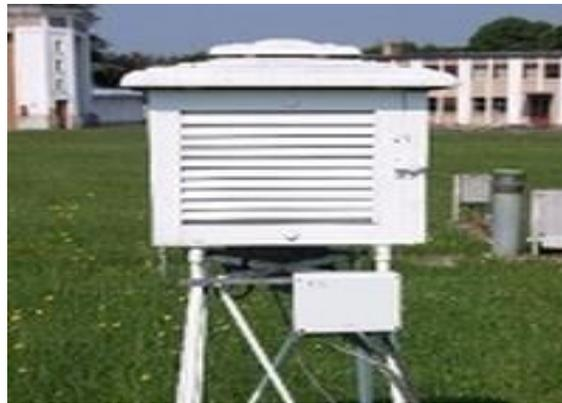
**Figure 7.** Un abri météo pour mesurer la température.
