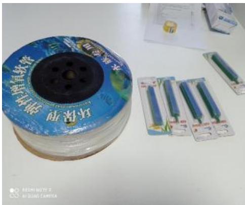
Figure 05 : Tuyau à l'air et diffuseur
