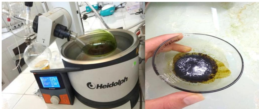
Figure09: appareil d'évaporation des extraits (université saaddahleb, 2022)
