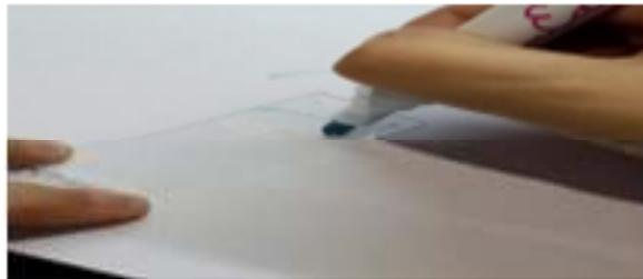
**Figure 40 : Entouré les coupes par la résine hydrophobe**
