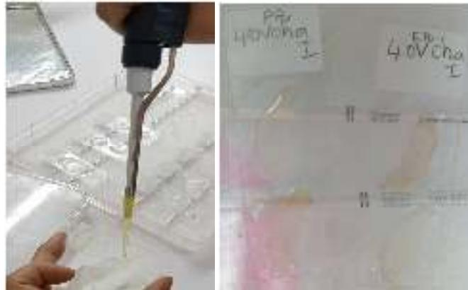
**Figure 47** : Application du chromogène diaminobinzidine sur les coupes.
