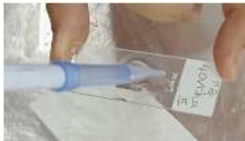
**Fig. 48** : Rinçage à l'eau distillée
