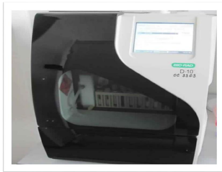
Figure 47 : Automate D10 pour le dosage de l'hémoglobine glyquée (photo originale).
