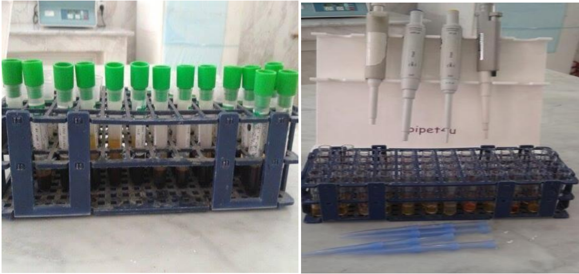
Figure 42 :1- Echantillons, 2- Micropipettes semi-automatique et fixe « 1000µl et 50µl », Portoir, Tubes hépariné et sec, Embouts de 1000µl ( photo originale ).
