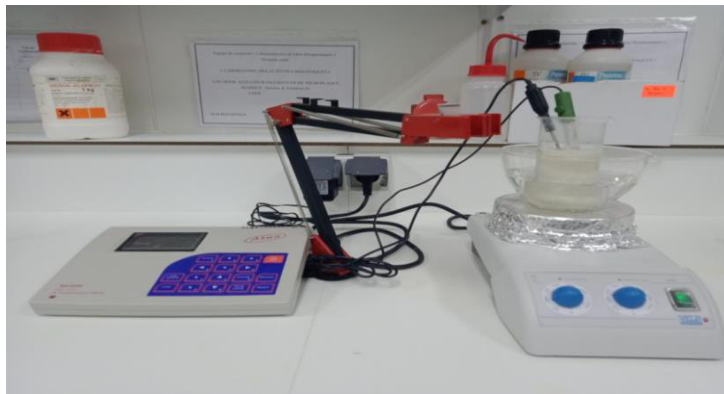
Figure 20: Dispositif de l'hydrolyse enzymatique des protéines des graines de courge, ( photos originales,2022)
