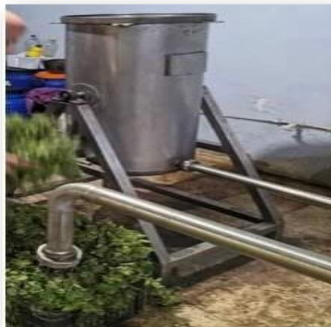
Figure 10 : Etuve de sterilisation
