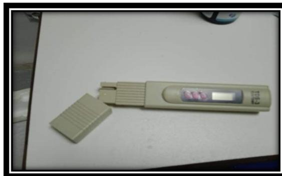
**Figure14** : Testeur électrique (TDS).
