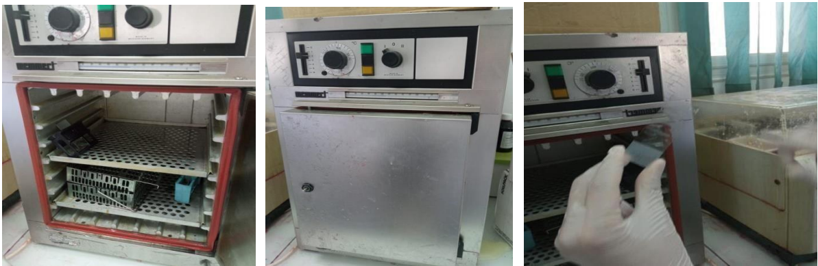
Figure 16. Technique de déparaffinage par l'étuve
