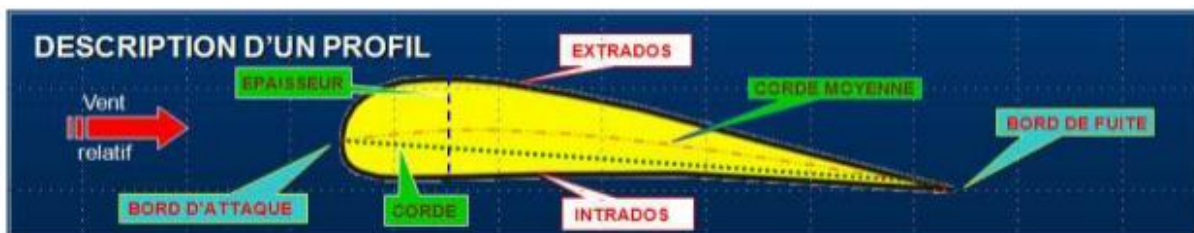
FIGURE 1. 2: le profil d'aile.
