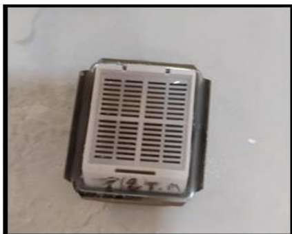
Collage des cassettes en plastique sur les moules de métal
