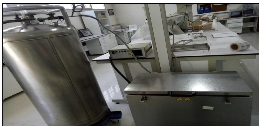
Figure 24 : Congélateur programmable par les vapeurs d'azote ( ORIGINALE , 2021).
