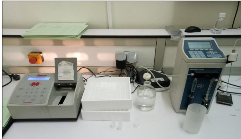
Figure 22 : Le diluteur à droite et le spectrophotomètre à gauche ( ORIGINALE, 2021 ).
