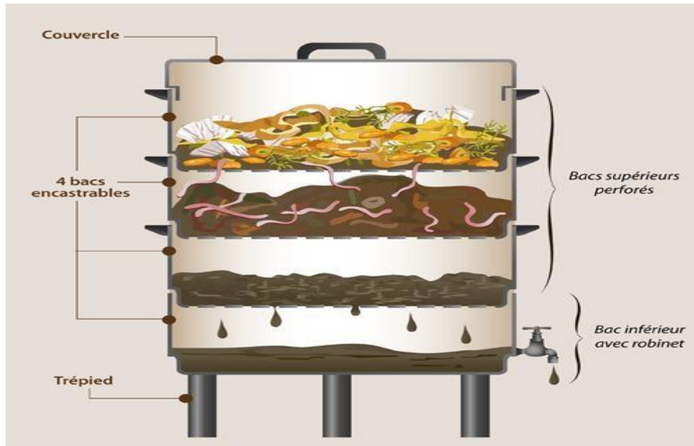
Figure 1: Vue intérieure d'un lombricomposteur avec ses différentes parties(Anonyme,2019)
