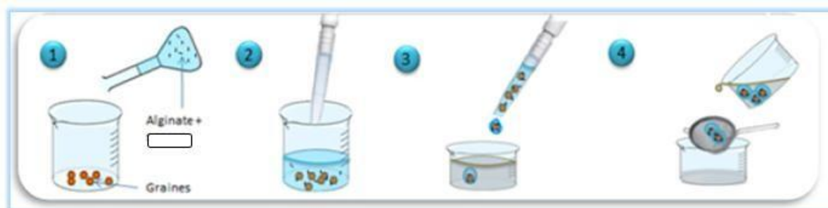
Figure 3: Protocole d'enrobage des graines par l'alginate
