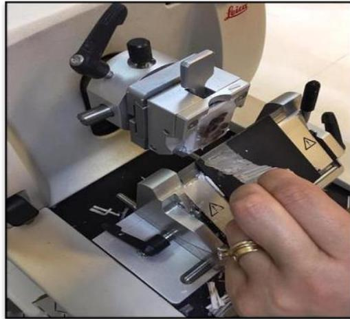
**Figure 27** : coupes fines par un microtome (**photo originale**)
