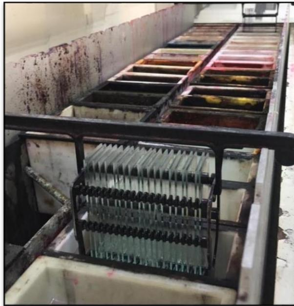
**Figure 29** : les étapes de la colorations dans un automate (**photo originale**).
