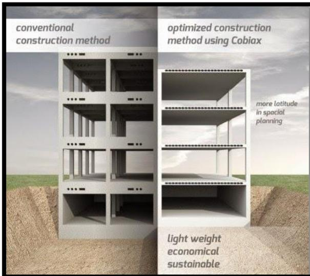
Fig33 comparaison entre un plancher de béton ordinaire et le plancher Cobiax (source : [http://www.techni.ch/technifin/haupt/batiment/sujet\\_0035/pdf/20\\_14\\_rapport\\_dalle\\_COBIAX.pdf](http://www.techni.ch/technifin/haupt/batiment/sujet_0035/pdf/20_14_rapport_dalle_COBIAX.pdf))
