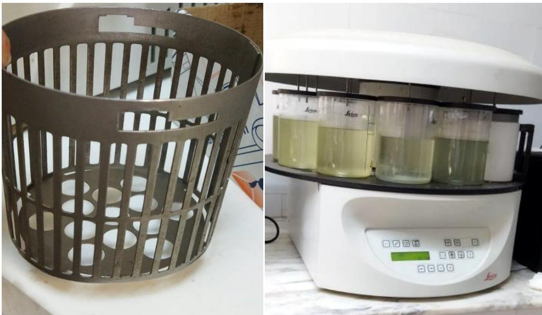
**Figure 21** : Panier des cassettes et automate de circulation (photo originale)
