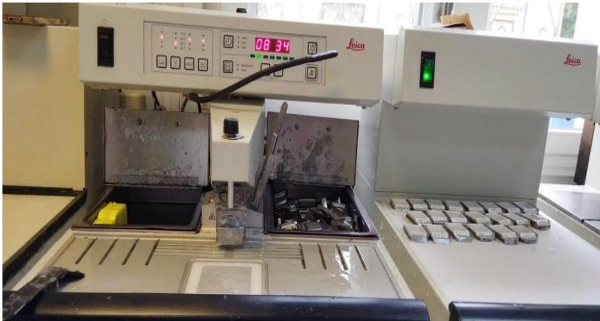
Figure 46: Station d'enrobage modulaire et refroidissant (Photo originale).
