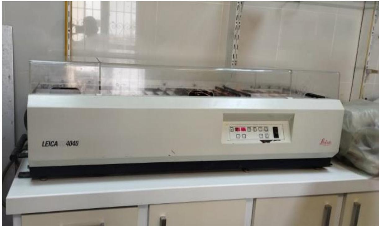
**Figure 44** : Automate de coloration (Photo originale)
