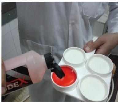
3<sup>ème</sup> étape : Ajout de 2 ml de réactif équivalente à 2 ml de lait dans chaque coupelle.
