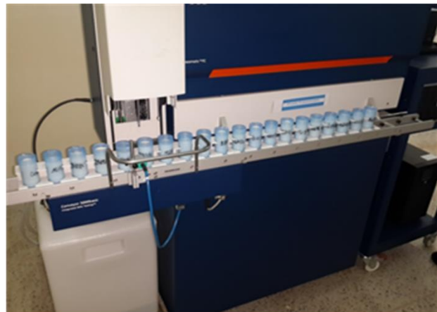
Analyse des échantillons de lait par Fossomatic
