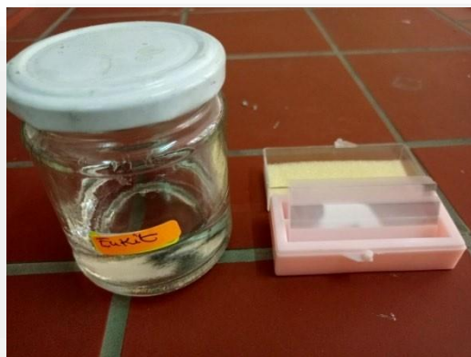
Figure 33 : Montage des lames par Eukit et lamelles (originale, 2022).
