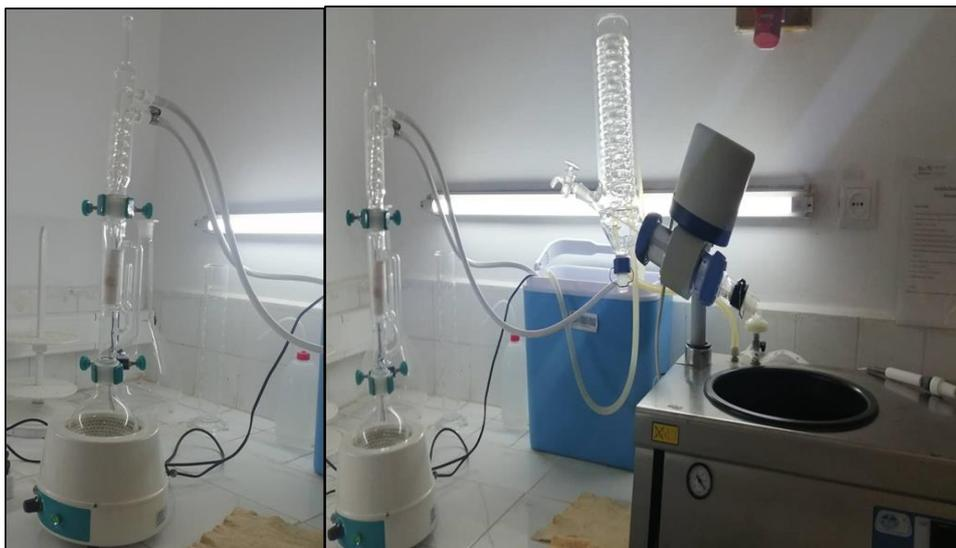
L'appareil de soxhlet
