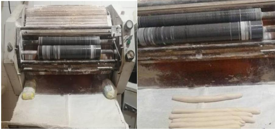
Façonnage à l'aide d'une Façonneuse mécanique
