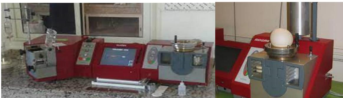
L'appareil d'alvéographe Chopin
