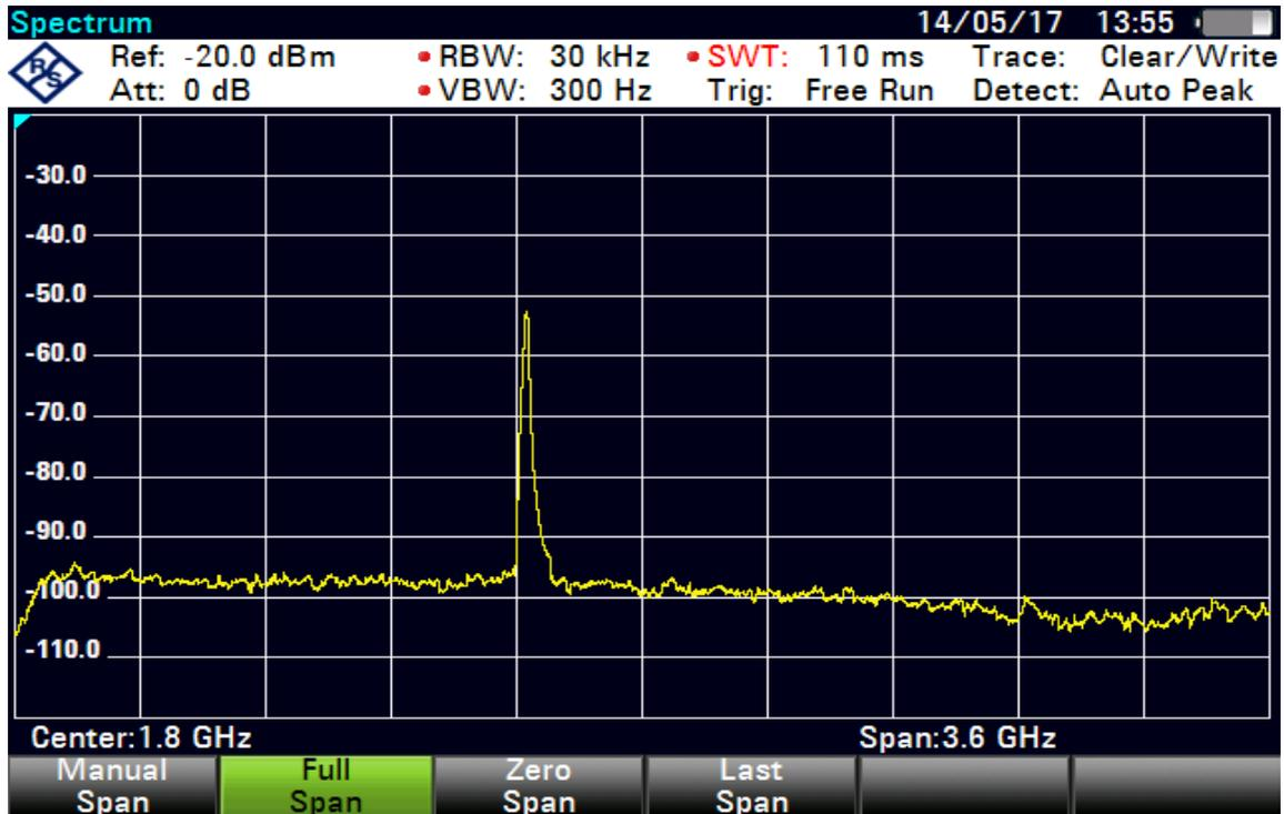
Figure 3.28. Porteuse obtenue après modulation.
