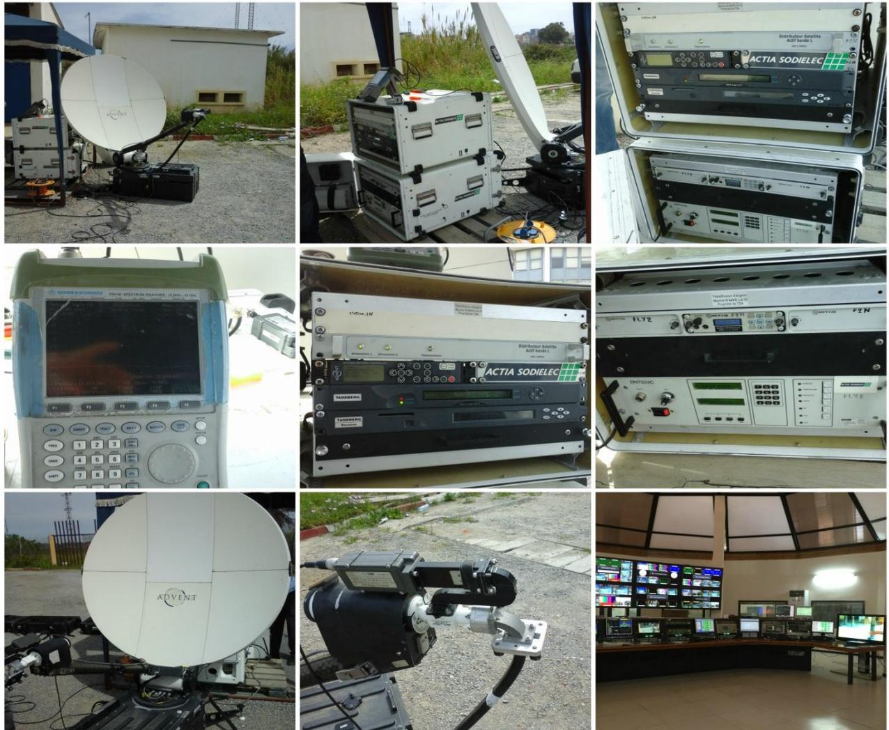
Figure 3.31. La chaîne de transmission DVB-S/DVB-S2 sur le satellite SES4 (22°W).
