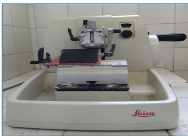
Figure 23: dispositif permettant de faire des coupes : microtome de type leica à gauche et plaque chauffante à droite (Originale).
