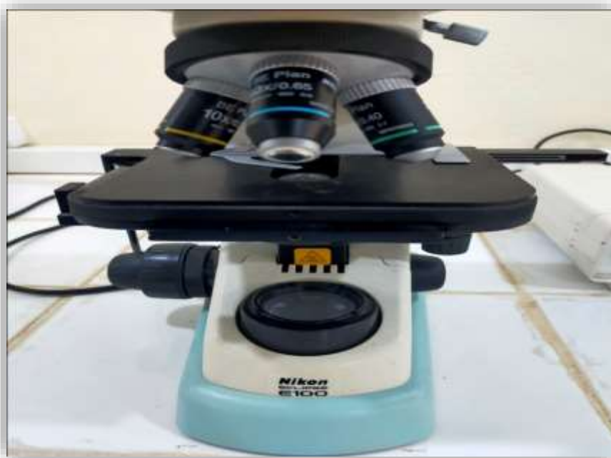
Figure N° 24: Microscope optique de marque NIKON E100 à platine chauffante
