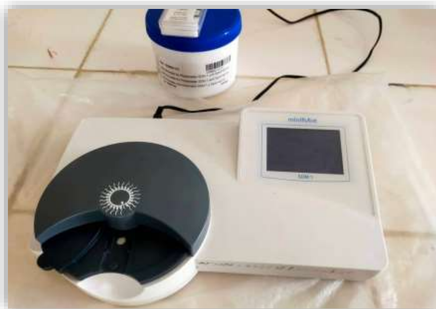
Figure N° 19: Photomètre calibré de marque SDM1 MINITUB
