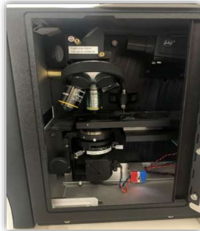
Figure N° 26: Présentation du microscope et camera intégrée de L'analyseur Hamilton-Thorne IVOS II
