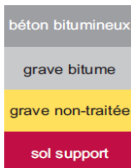
Figure : (I.1) les différentes couches de matériaux Chaussées souples
