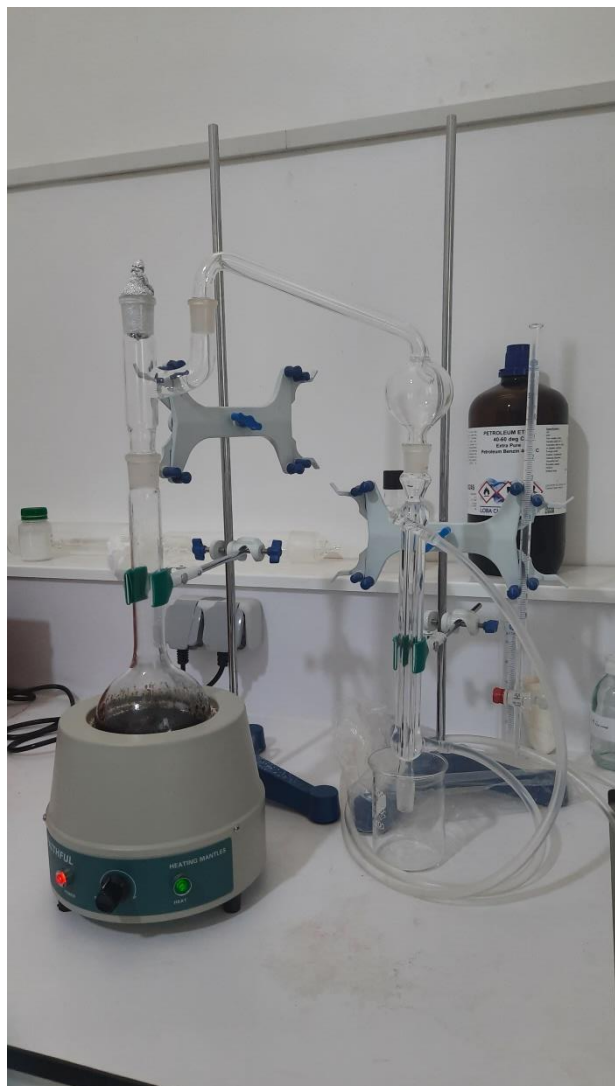
Appareil utilisé dans méthode de kjeldhal
