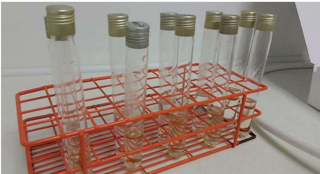
**Figure 20 :** Dilutions décimales ( $10^{-1}$  et  $10^{-2}$ ) de la limonade dans la solution TSE (photo originale)
