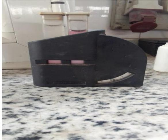
**Figure 6 :** Détermination du taux de chlore par analyseur de chlore colorimétrique – LAVIBON (Photo originale)
