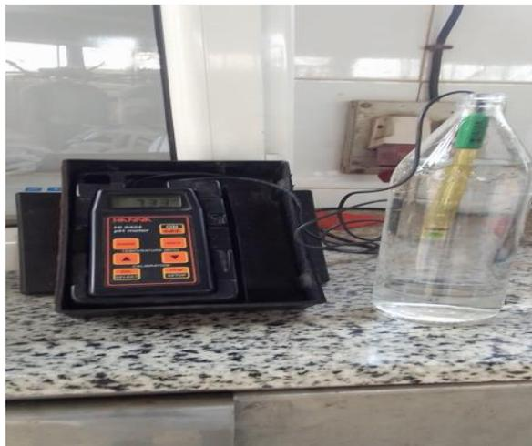
**Figure 7 :** Détermination du pH de l'eau par le pH-mètre (Photo originale)
