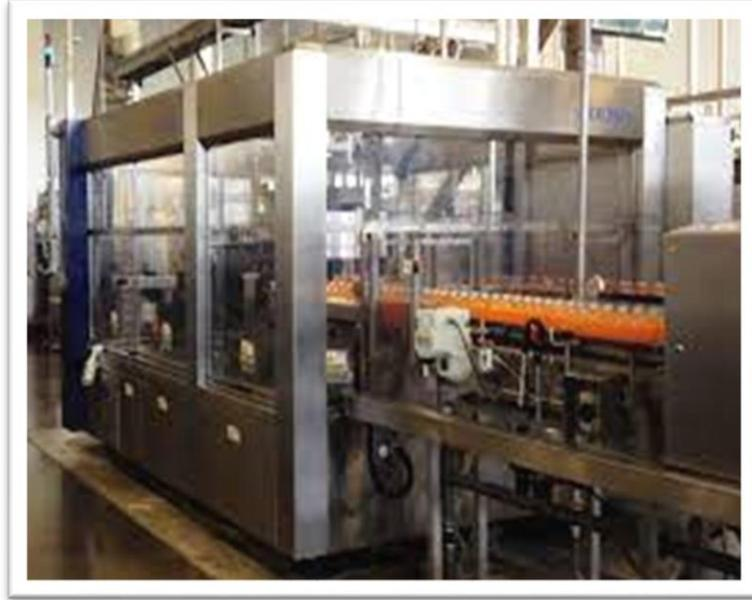
**Figure 4 :** Machine étiqueteuse pour les boissonsKRONES([mectilesitalia.com](http://mectilesitalia.com)).
