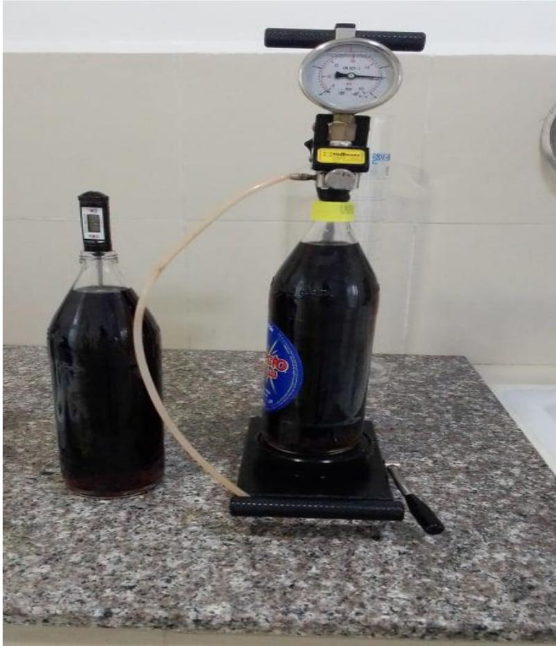
**Figure 12 : Détermination de la pression et le volume de CO<sub>2</sub> (Photo originale)**
