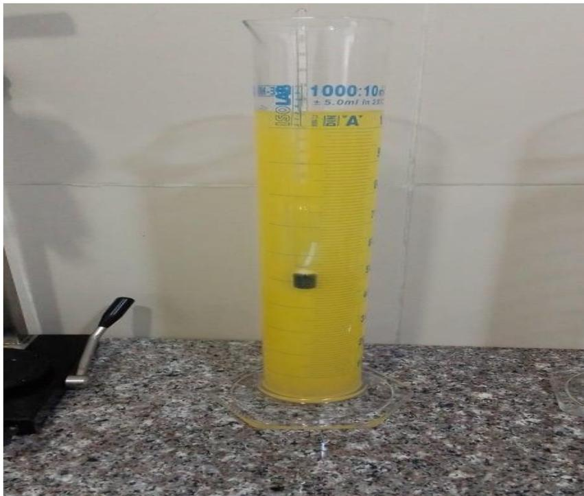
**Figure 13** : Détermination de la densité de la limonade (Photo originale)
