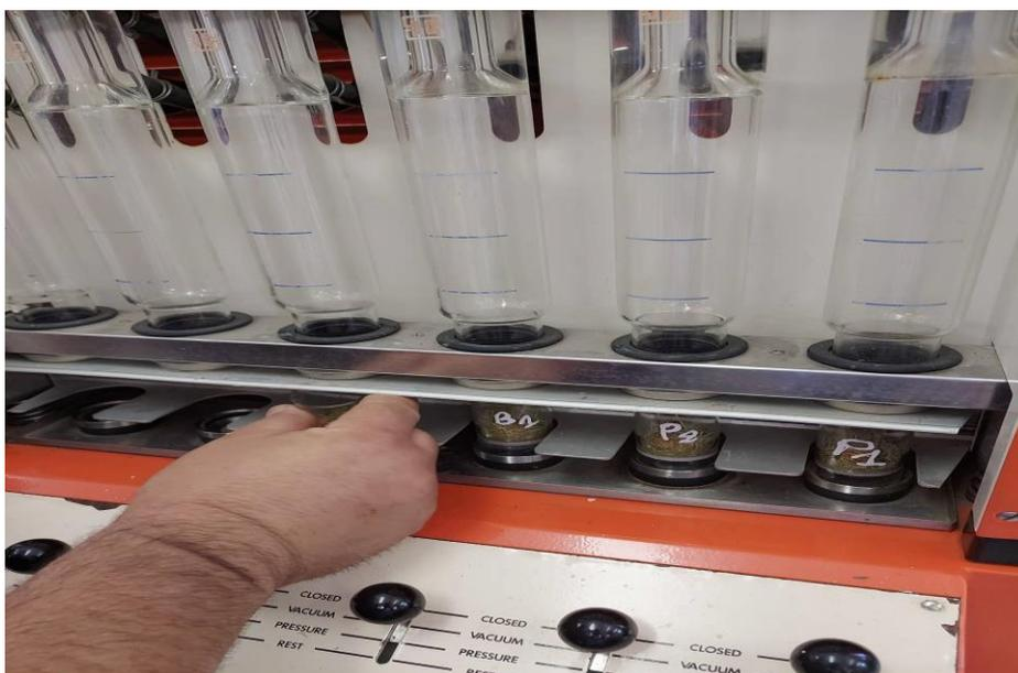
**Figure 24** : Mise des creusets contenant 2g d'échantillon dans l'analyseur des fibres brutes. (Original, 2022)
