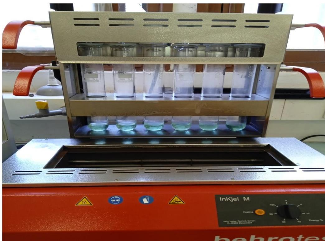
**Figure 25** : Les matras après le chauffage et l'obtention de la coloration verte stable. (Original, 2022)
