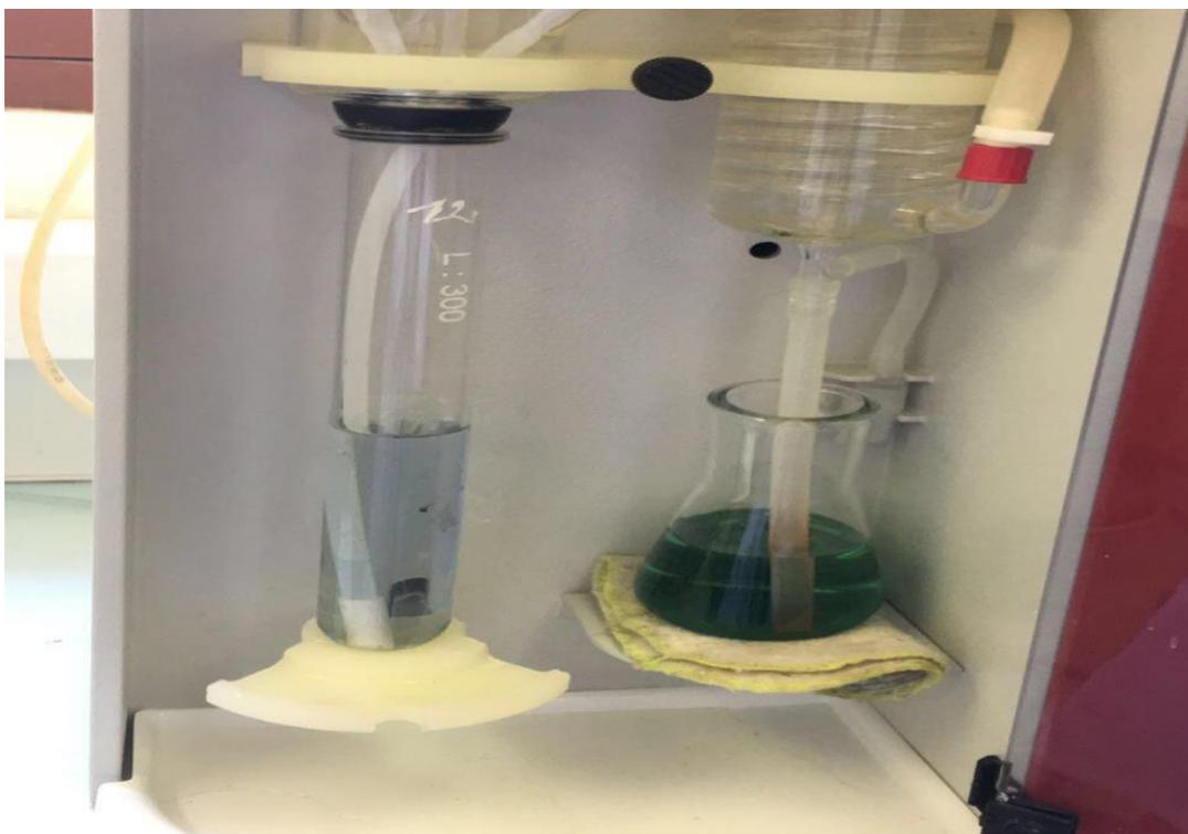
**Figure 26** : Lancement de cycle de distillation et l'apparition de couleur verte.
