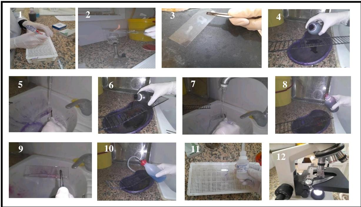
**Figure 15** : Les étapes de la coloration de Gram (**photos originales**).
