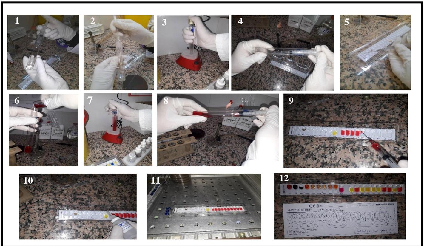
**Figure 20 :** Les étapes de la réalisation de la galerie Api Strep (**photos originales**).
