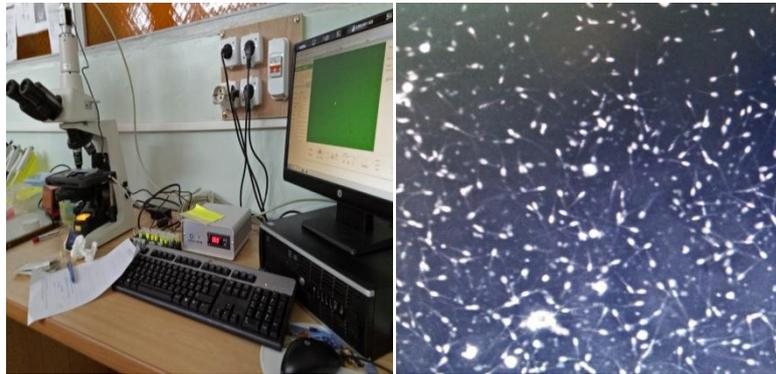
**Figure 25**: Microscope à platine chauffante (évaluation automatisée)
