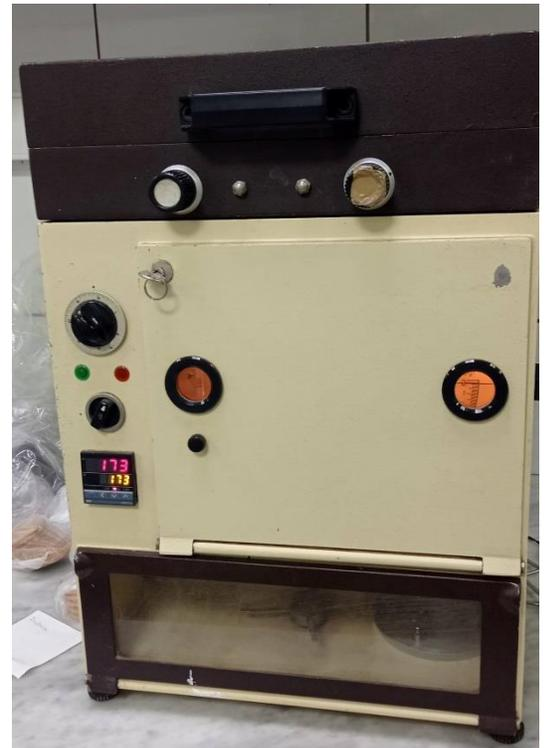
**Figure :** Humidimètre de céréales
