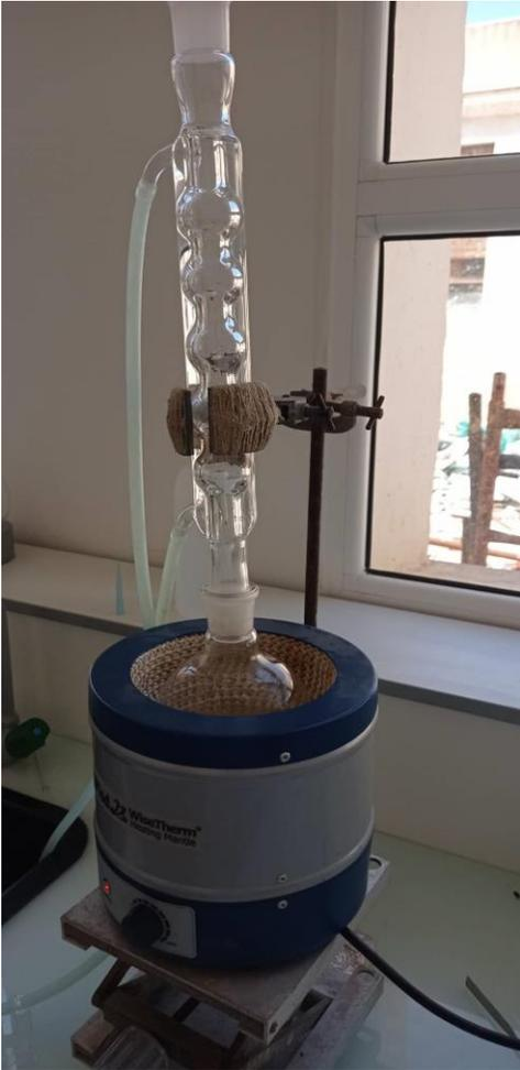
**Figure :** Dispositif d'extraction des fibres totales
