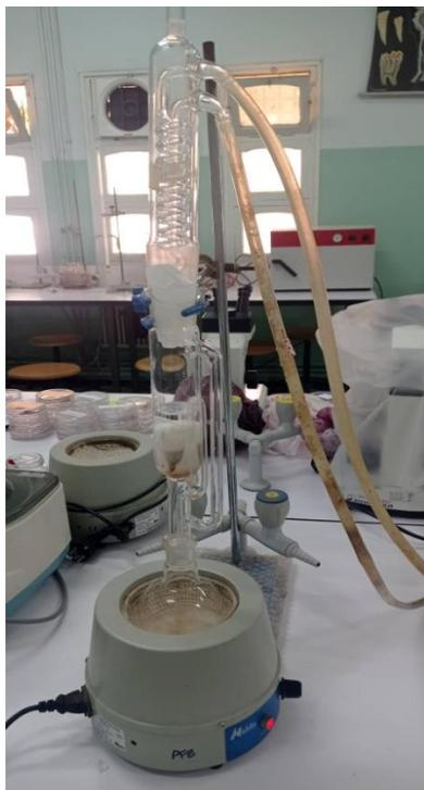
**Figure :** Dispositif d'extraction des lipides
