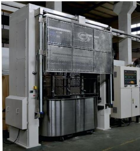
**Figure 13** : Mélangeur vertical à trois broches et capacité de 1000 kg **(Iain Davidson, 2018)**.
