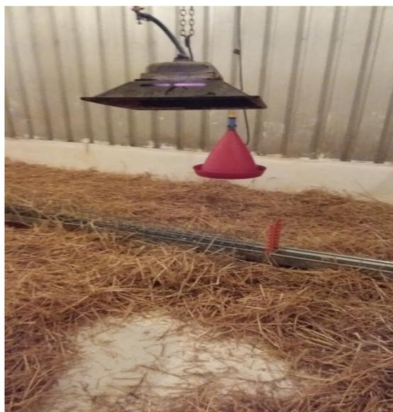
Figure 12 : Radiant à gaz.
