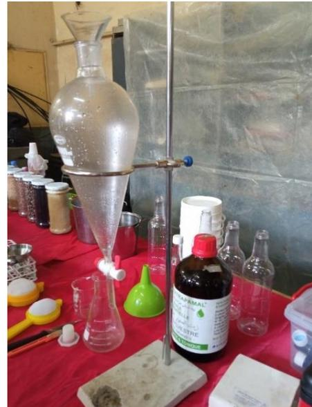
**Figure 2 : Ampoule à décantation**
