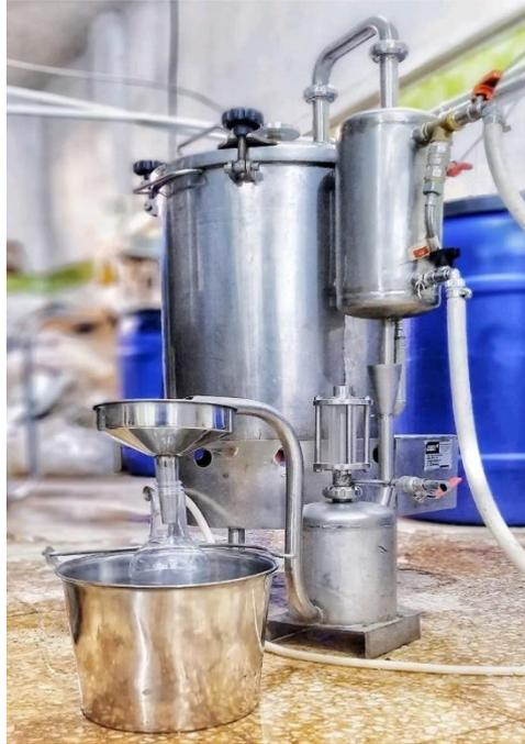
**Figure 12 : Alambic d'hydro distillation**
