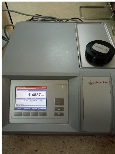
Figure 13 : Réfractomètre
