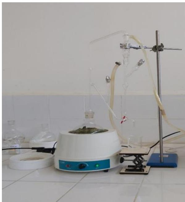
**Figure 15 :** Hydrodistillation des feuilles d'olivier (Dispositif Clevenger).
