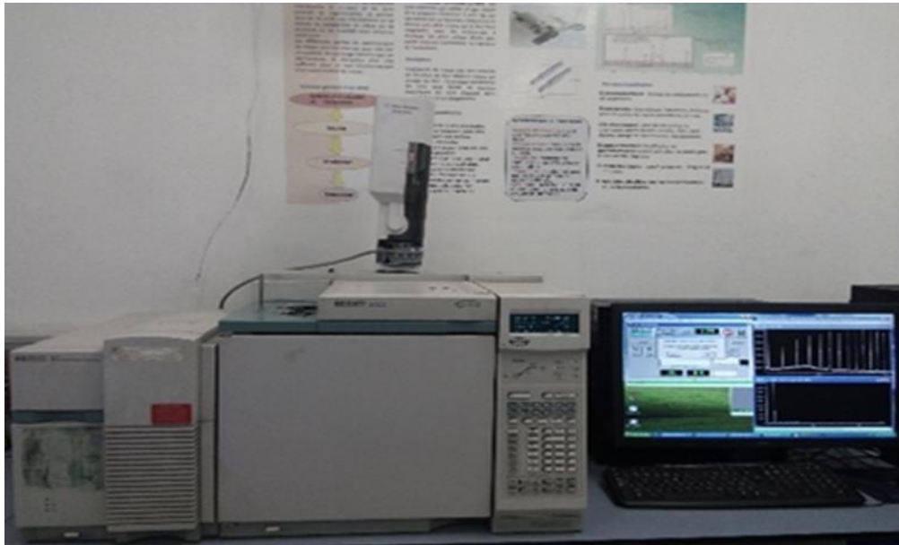
Figure 7 : Appareil de la chromatographie gazeuse couplée à la spectrométrie de masse (GC/MS), laboratoire C.R.A.P.C (photo original).
