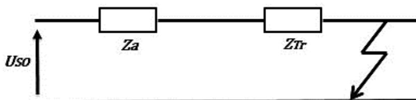
Figure IV. 4. Schéma équivalent du circuit de défaut.
