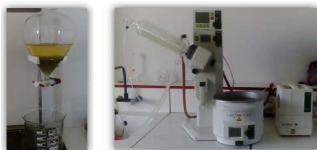
Figure 7 : A gauche un évaporateur rotatif «l'appareil d'extraction »et à droite une ampoule à décantation.
