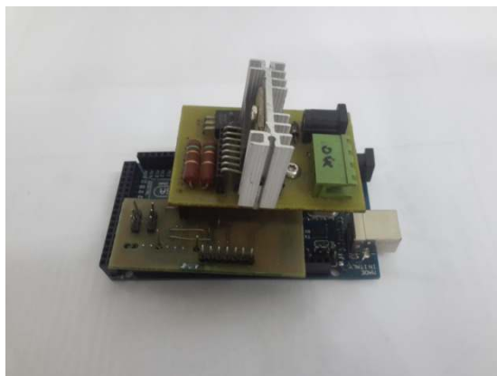
Figure 3.15 La carte arduino Méga associée à la carte de puissance
