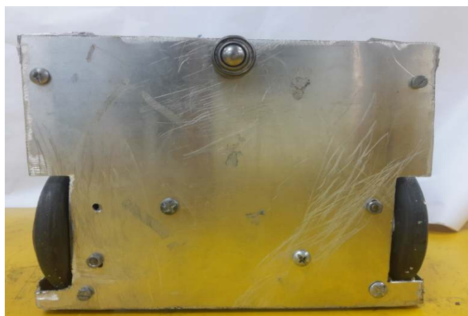
Figure 3.9 Plateforme (châssis) du robot secondaire
