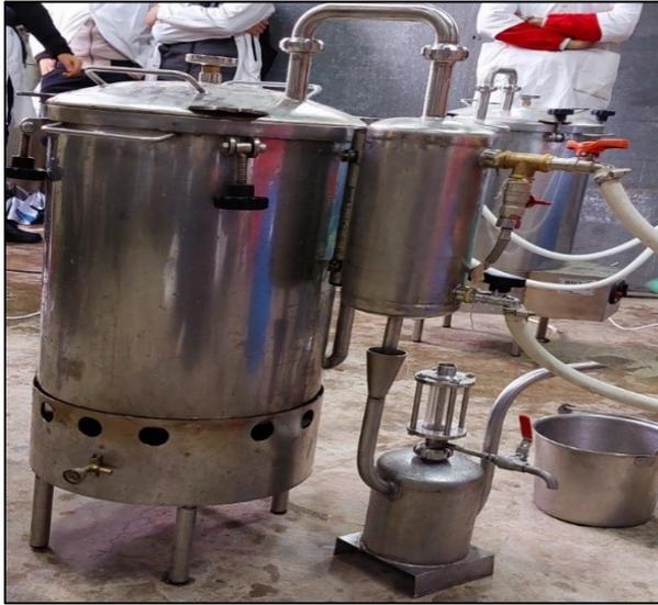
**Figure 24** : montage de l'hydro-distillateur semi-pilote (photo originale ,2022)
