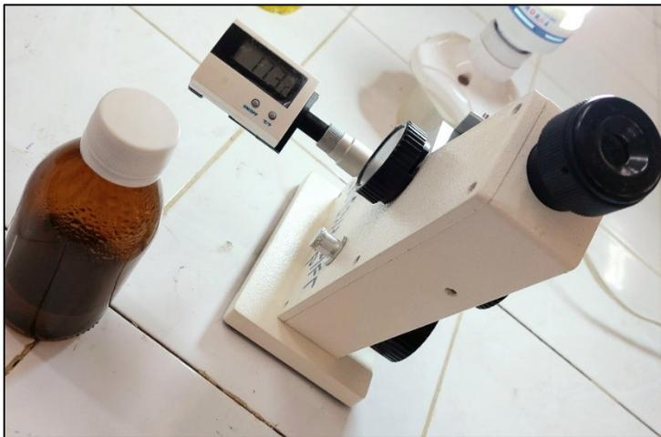
**Figure 33** : l'appareil refractomètre pour mesurer indice de réfraction (photo originale,2022)
