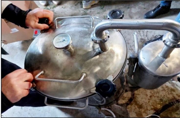
**Figure 26 :** Etape de contrôle de l'appareil l'hydro-distillateur (photo originale,2022)
