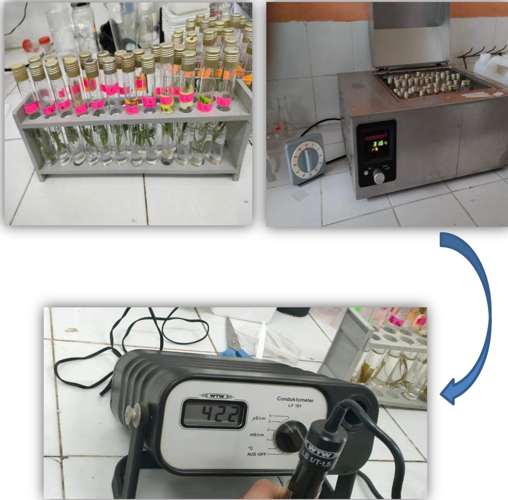
Figure n°24 : Détermination de fuite d'électrolyte
