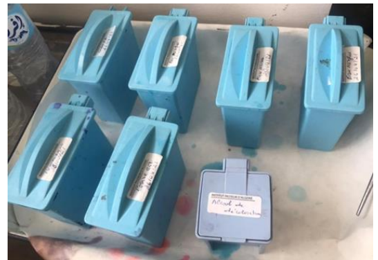
Figure 40 : Bacs et panier de coloration.
