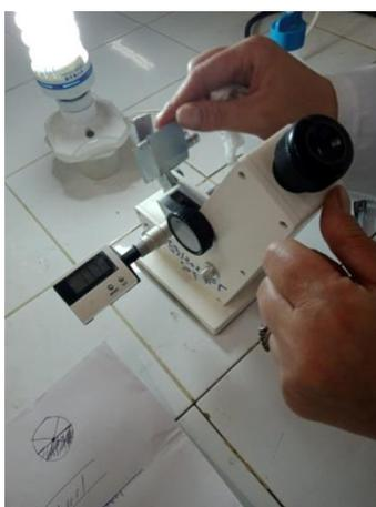
**Figure IV-4:** réfractomètre
