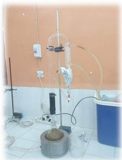
**Figure IV-3:** Dispositif d'hydro distillation clvenger
