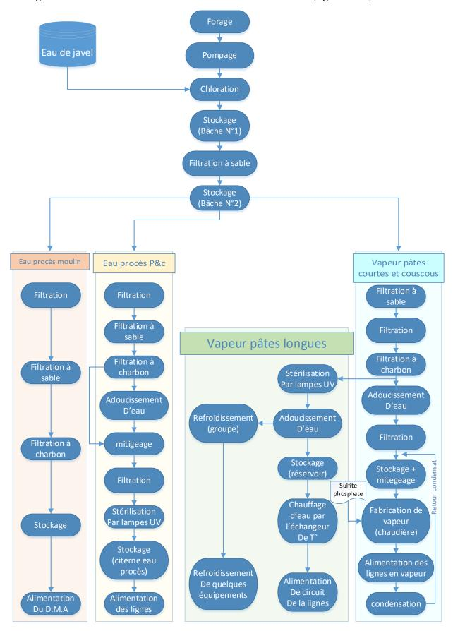
Figure IV. 2 : Diagramme de traitements des eaux chez SOPI.
