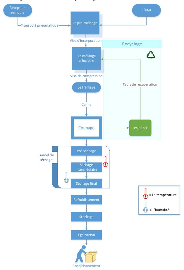
Figure V. 5: Diagramme de fabrication des pates longues (Originale)
