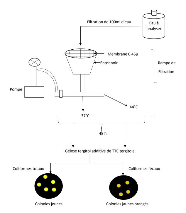
Figure 7: Recherche et dénombrement des coliformes dans l'eau (SOPI).
