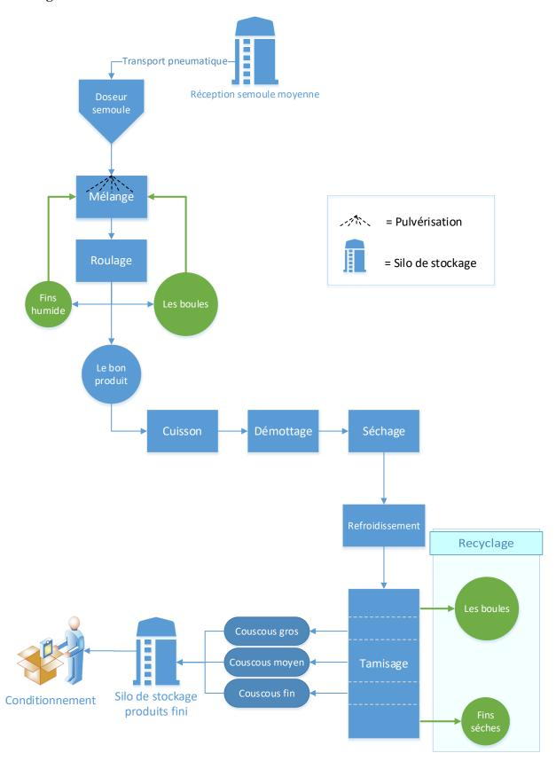
Figure V. 6: Diagramme de fabrication du couscous (Originale)
