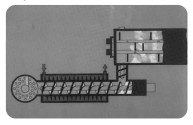
Figure V. 2: Presse à vis continue (Dawe et al., 2001).
