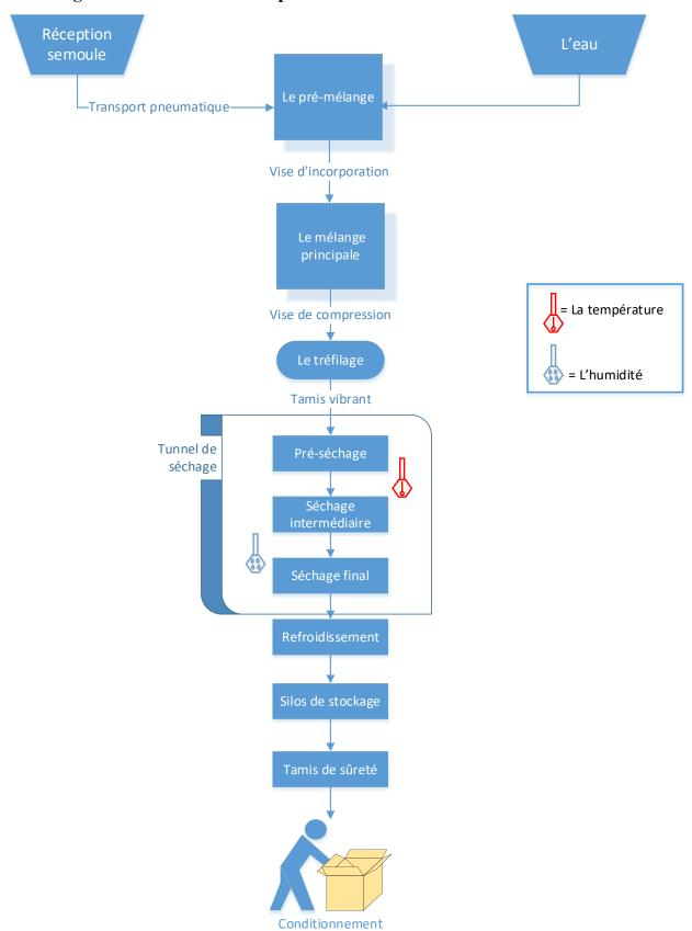
Figure V. 4: Diagramme de fabrication des pates courtes (Originale)
