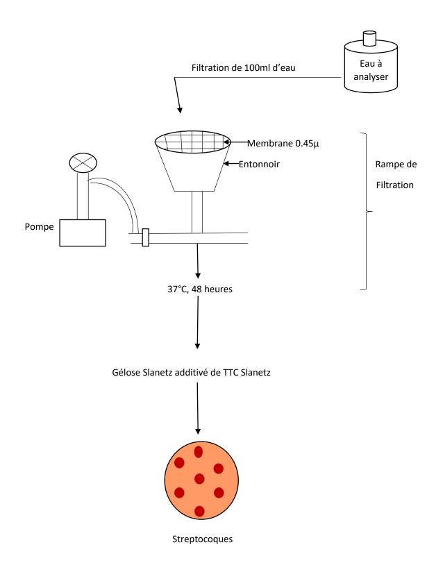
Figure 8 : Recherche et dénombrement des streptocoques dans l'eau (SOPI).
