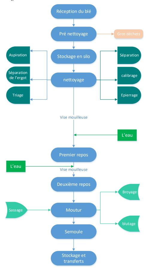
Figure V. 3: Diagramme de fabrication de la semoule (Originale)
